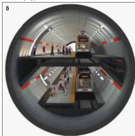
Рис. 5. Размещение путей в тоннеле: а – параллельно; б – в двух уровнях
