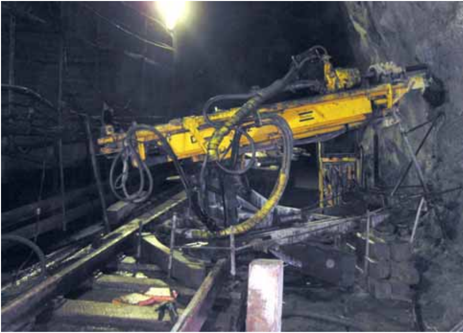
Рис. 1. Бурение скважин станком горизонтального бурения ДИАМЕК-262
