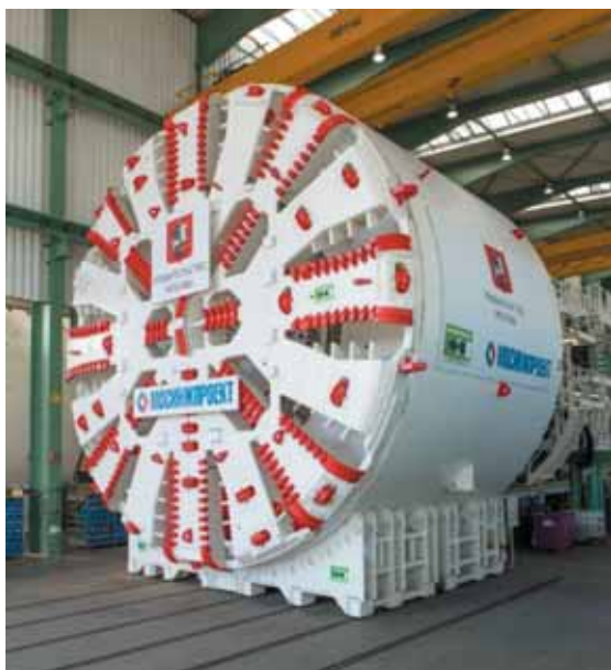
Рис. 8. Общий вид ТПМК D_{нар} = 10,82 м для сооружения двухпутных тоннелей в Москве
