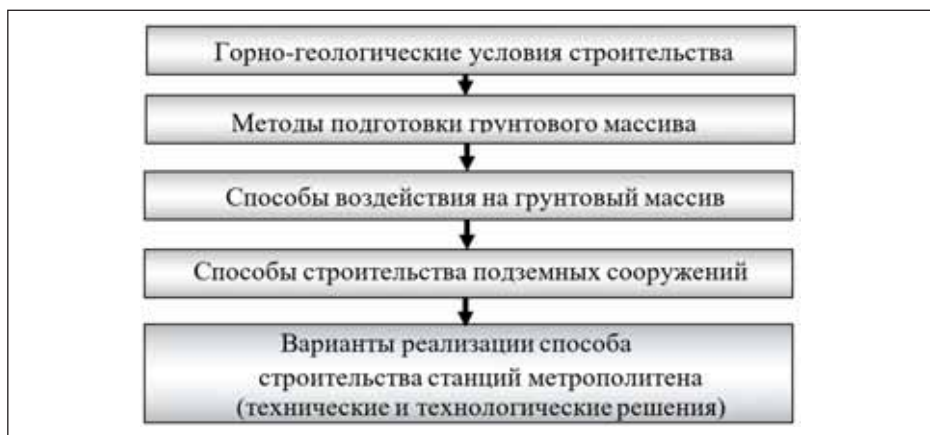
Рис. 8. Структура оптимизации технологии строительства станций метрополитена
