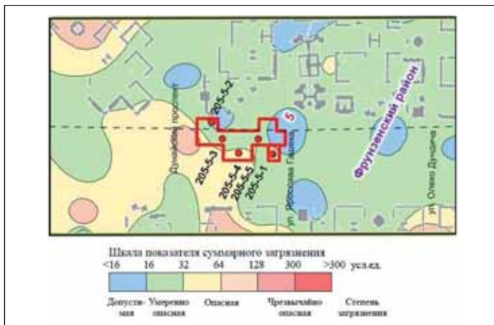
Рис. 13. Схема суммарного загрязнения тяжелыми металлами почвогрунтов участка для строительства ст. «Дунайский проспект»
