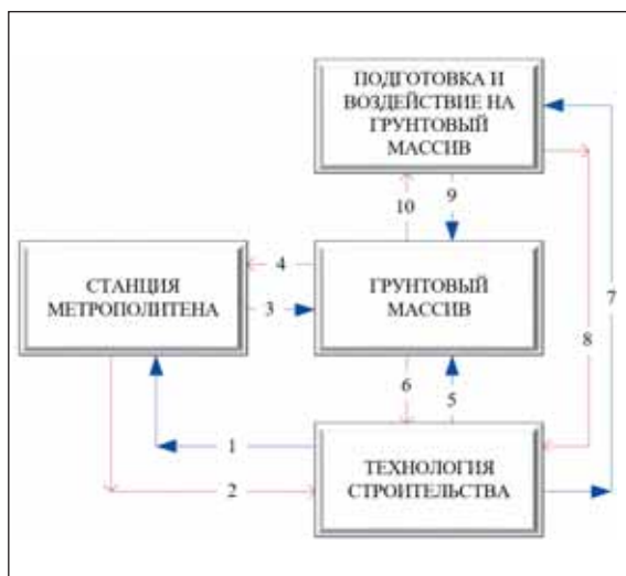
Рис. 1. Схема динамической системы «массив – технология строительства – станция»
