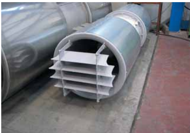
Рис. 1. Установка направляющего дефлектора
