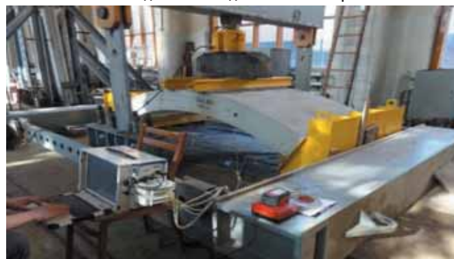
Рис. 10. Испытание обделки на стенде АО «НИИМосстрой»
