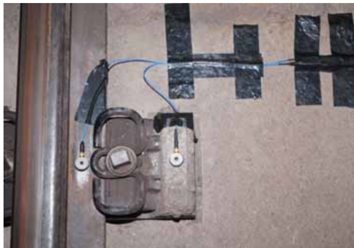
Рис. 10. Внешний вид датчиков, установленных на подошве рельса и опоре
