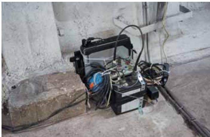
Рис. 9. Внешний вид сейсмостанции с ноутбуком, подключенный через переходной интерфейс
