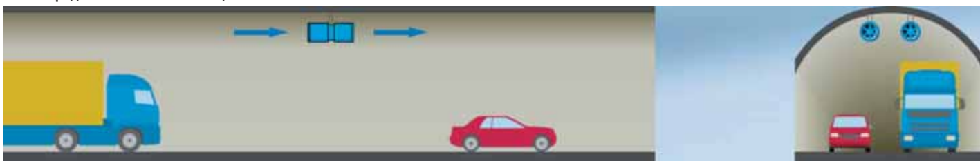
Рис. 2. Продольная схема вентиляции
